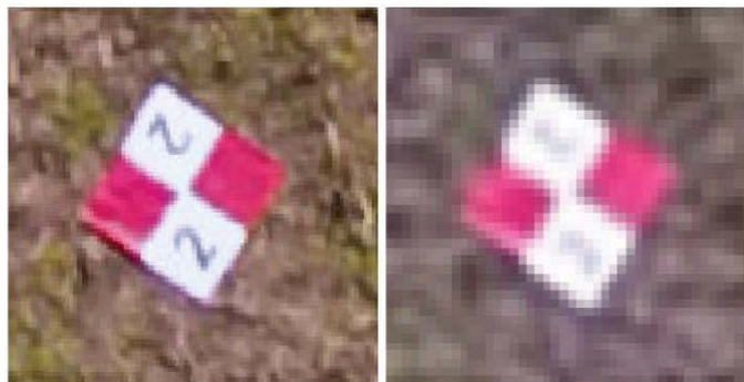
Figura 7. Detalle del marcador M2 visto en la ortofoto generada a partir de misiones de vuelo realizadas a diferente altura: Izquierda: 50 m AGL; Derecha: 100 m AGL.
