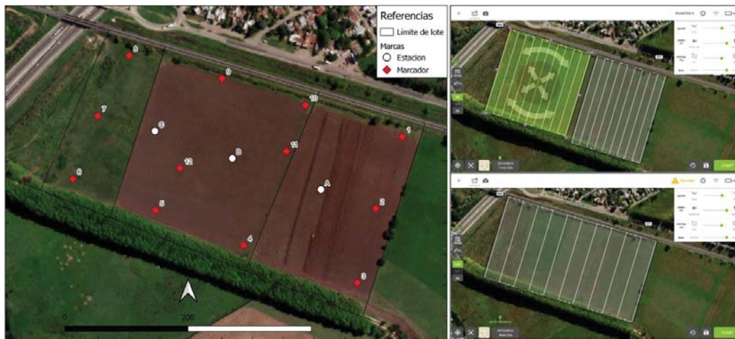
Figura 2. A la izquierda: Diseño en gabinete de la distribución de marcadores (en números) y estaciones de relevamiento (en letras) sobre una imagen satelital (Google Satellite en QGIS) del área de trabajo. A la derecha: capturas de pantalla de las misiones de vuelo programado a 50 m AGL (arriba) y a 100 m AGL (abajo), en el Software: Pix4D Capture.
