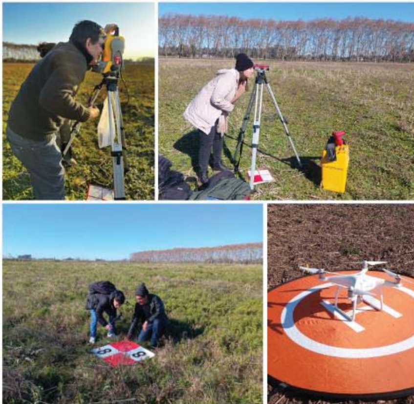
Figura 3. Contexto y equipamiento utilizado para el relevamiento de campo. Arriba a la izquierda: estación total; arriba a la derecha: nivel óptico; abajo a la izquierda: marcador; abajo a la derecha: homepoint con el dron previo al despegue.
