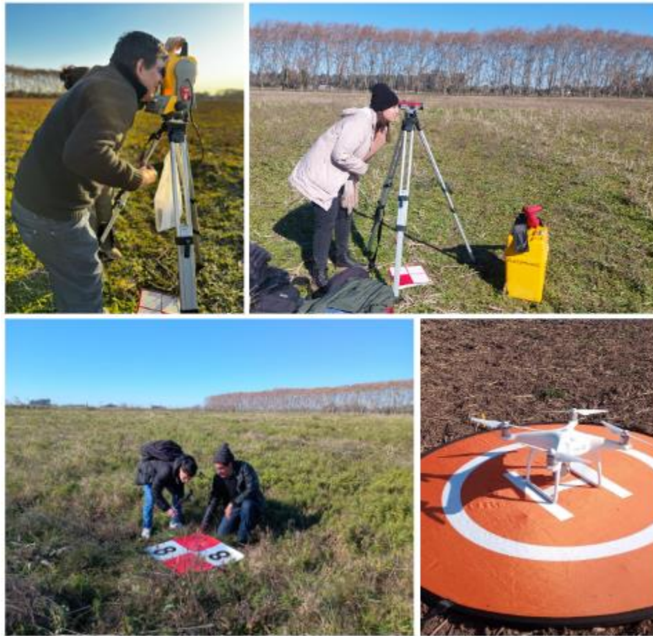
Figura 3. Contexto y equipamiento utilizado para el relevamiento de campo. Arriba a la izquierda: estación total; arriba a la derecha: nivel óptico; abajo a la izquierda: marcador; abajo a la derecha: homepoint con el dron previo al despegue.
