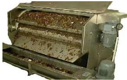
Figura 5. Sistema de Roto Filtro.
